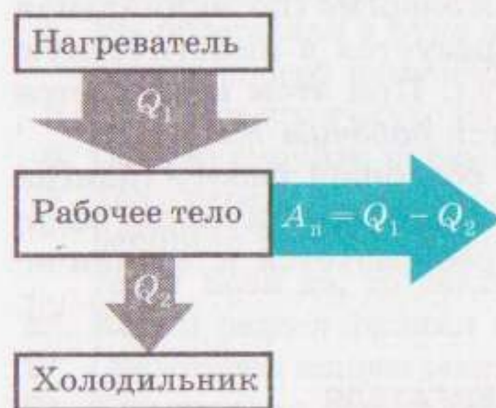
Рис. 32.1. Основные элементы теплового двигателя и превращения энергии при его работе
