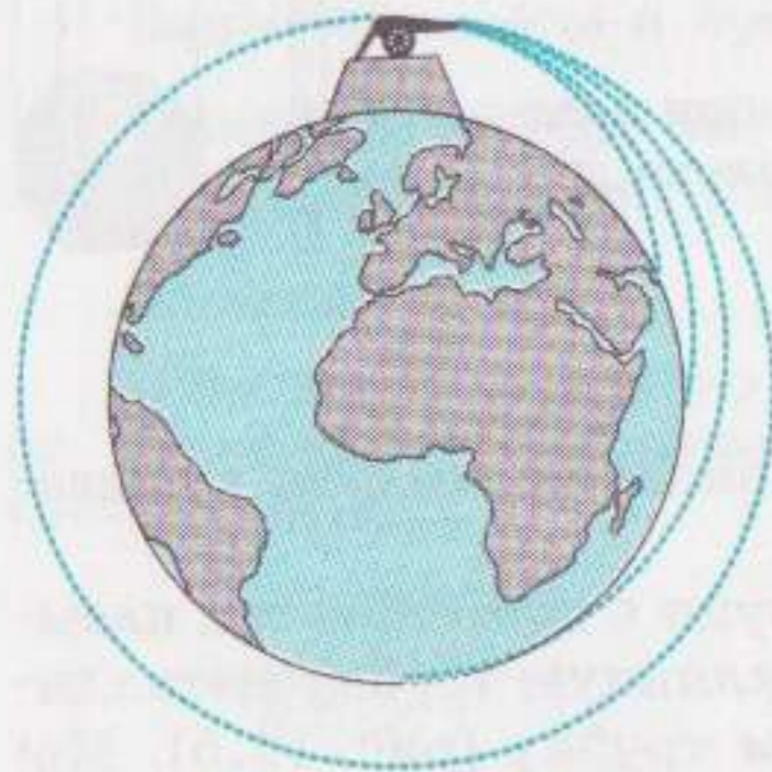
Рис. 12.6. Схема запуска искусственного спутника Земли, предложенная Ньютоном
