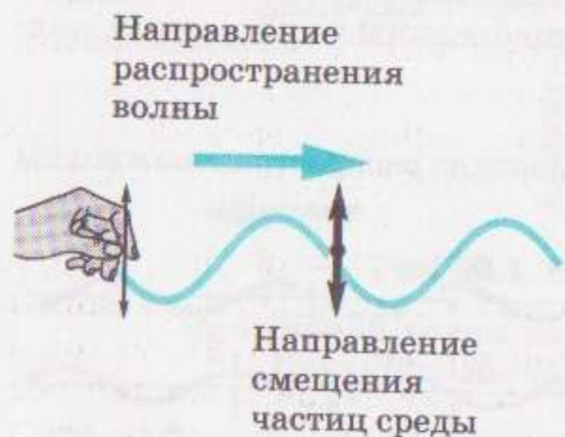
Рис. 23.5. Пример поперечной волны: волна, бегущая по шнуру, когда источник колебаний совершает колебания поперек шнура
