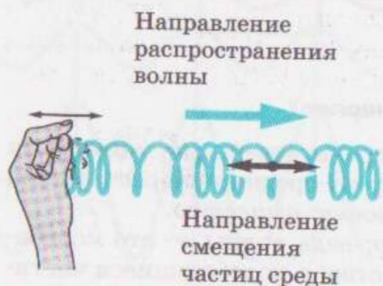
Рис. 23.6. Пример продольной волны: разрежения и сжатия, бегущие вдоль пружины, когда источник колебаний совершает колебания вдоль пружины
