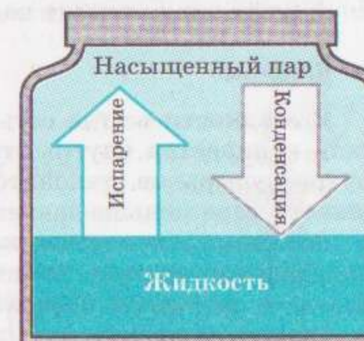
Рис. 35.1. Насыщенный пар над поверхностью жидкости в закрытом сосуде
