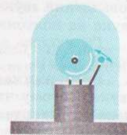
Рис. 23.8. Звонок под колоколом воздушного насоса
