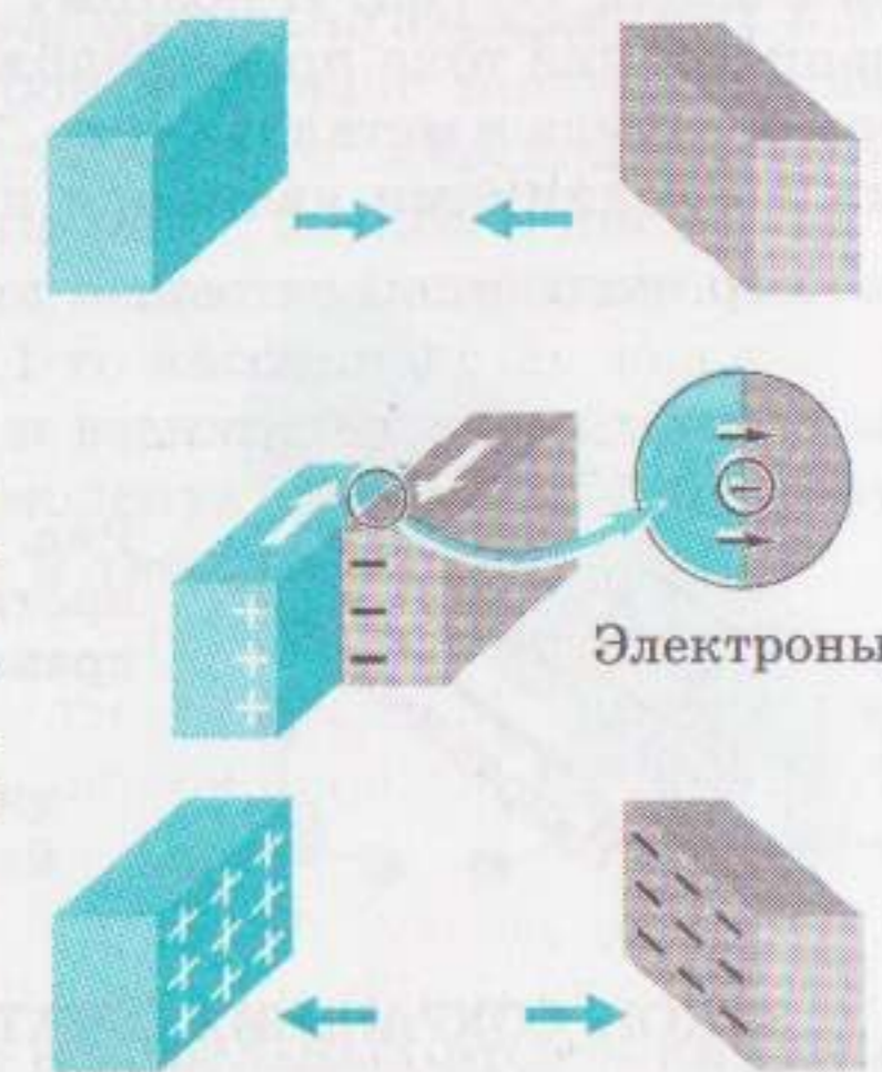
Рис. 36.3. Механизм электризации трением
