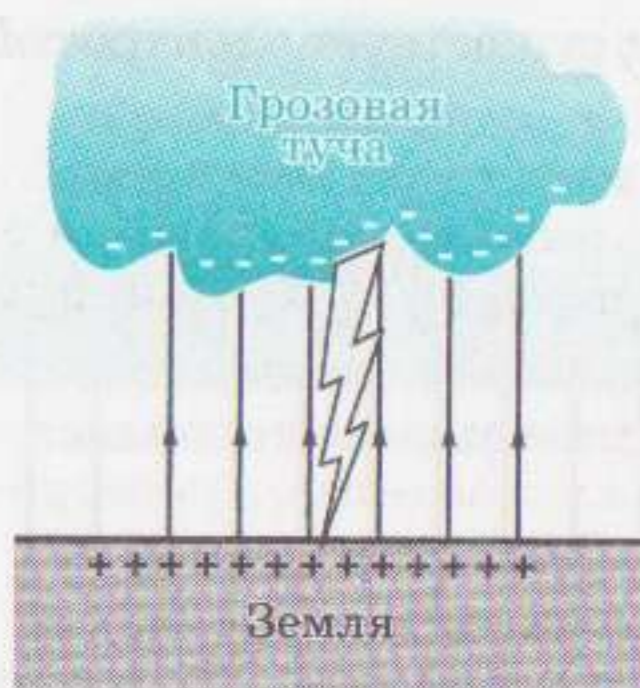
Рис. 40.9. Распределение электрических зарядов в грозовом облаке и у поверхности Земли
