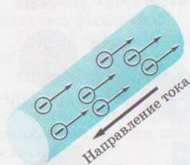
Рис. 36.4. Электроны в металле движутся противоположно условно выбранному направлению тока
