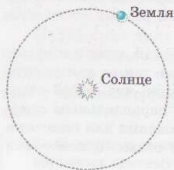
Рис. 1.4. Землю можно считать материальной точкой при рассмотрении силы, действующей на нее со стороны Солнца.
