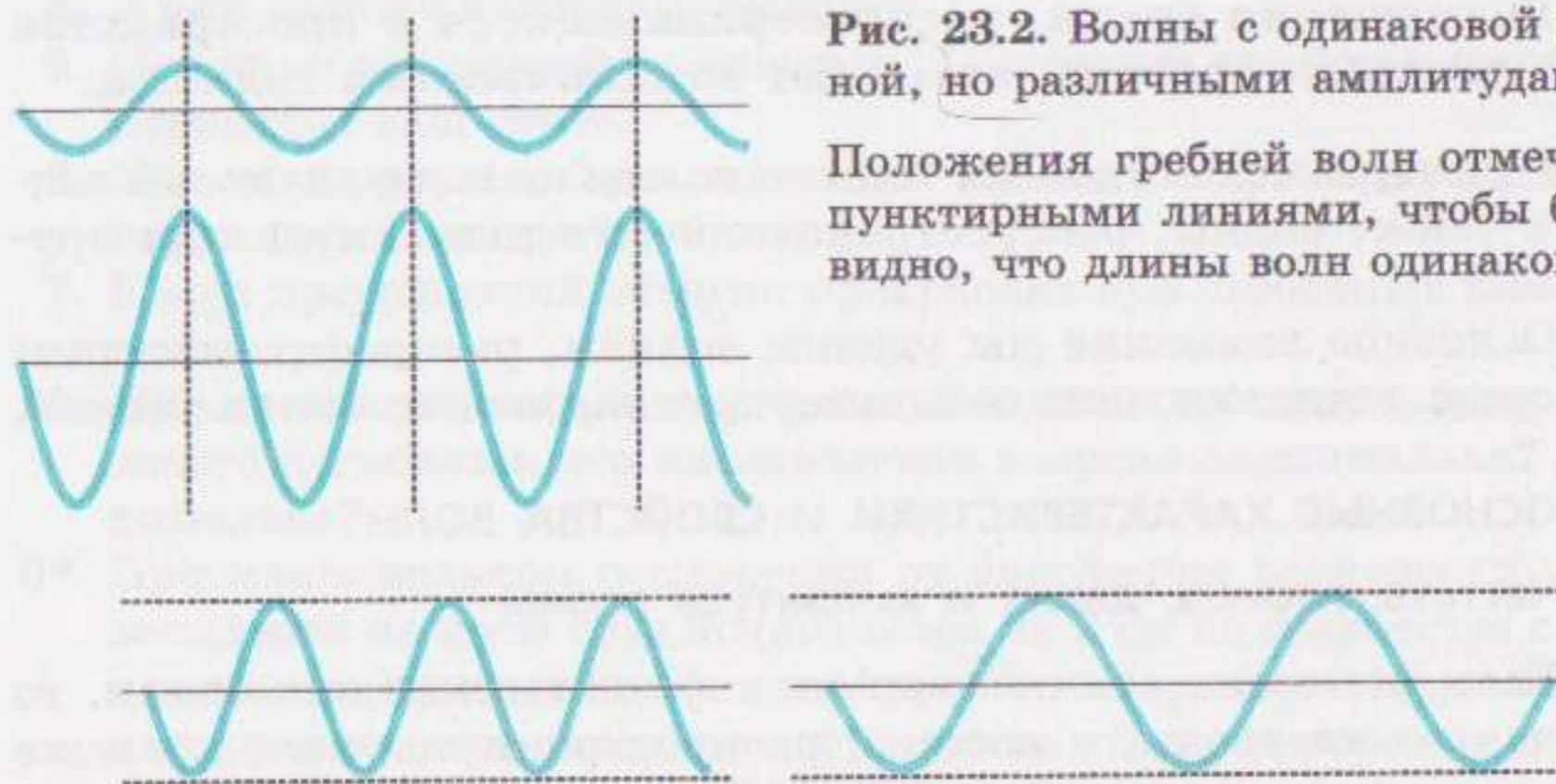
Рис. 23.3. Волны с одинаковой амплитудой, но различными длинами волн
