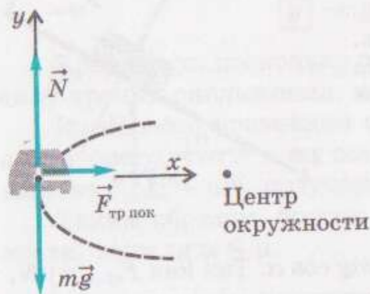
Рис. 15.4. Силы, действующие на автомобиль при повороте
